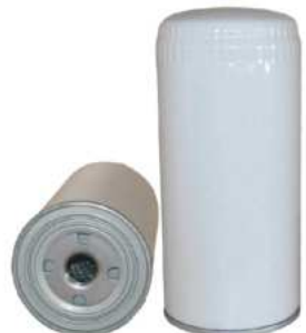
TMY-HS-0916 ATLAS COPCO : 1625752500 1613610500 2903752501 ODXH : Φ92*205 Thread : M23 x 1.5 Application : ATLAS COPCO
